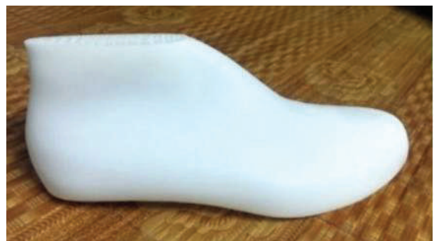
Hình 4. Hình ảnh phom mẫu cho BNĐTĐ được in 3D
