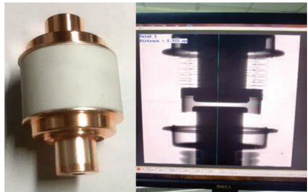
Hình 1. Hình dạng bên ngoài và cấu trúc bên trong của buồng dập hồ quang (tiếp điểm chân không 400A)
