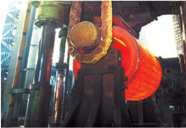
Hình 5. Máy rèn thủy lực 13000 tấn tại Doosan - Hàn Quốc, chuyên dùng để gia công thiết bị chính nhà máy điện hạt nhân
