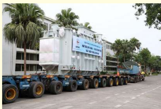
Máy biến áp 70 MVA - 132/33 kV di chuyển từ Nhà máy Thiết bị điện Đông Anh tới Cảng Hải Phòng
